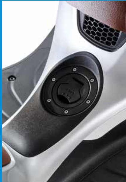
TAPÓN DEL DEPÓSITO DE GASOLINA EN EL TÚNEL CENTRAL
